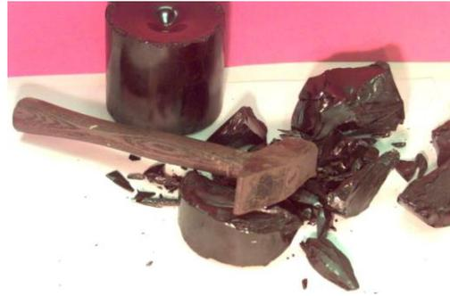
Cette expérience démontre que la poix (coulée ici à chaud dans l'entonnoir avant l'expérience) bien que tout à fait solide en apparence à température ambiante (photo de droite après un coup de marteau) est en réalité un fluide doté d'une très forte viscosité : la poix s'écoule en effet de l'entonnoir à raison d'une goutte toutes les .. huit années...
